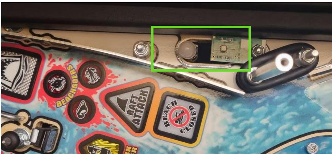
Das Kabel hinter dem Leitblech entlang führen, bis in die hintere, rechte Ecke des Spielfeldes.
